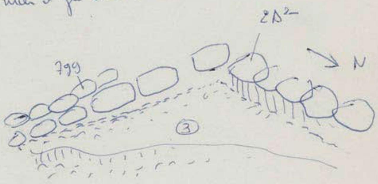
le drain repose sur le gravillon
